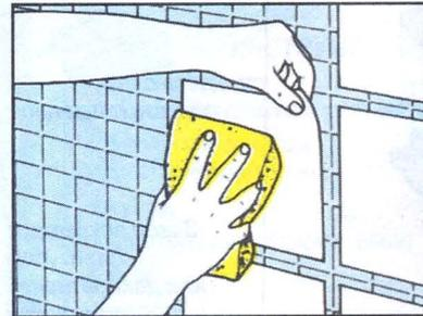
Когда клей высохнет, губкой, намоченной в теплой воде, увлажняют бумажную основу (покрытие) и снимают ее. Удалив из швов выдавившийся туда клей, швы затирают.
