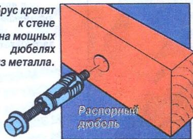
Итак, для определения мест установки опор крепят несущий брус к стене и натягивают обноску (в нашем случае - шнур). Все точки пересечения указывают места установки опор. Правильность разметки контролируют, измеряя диагонали прямоугольных участков террасы. Диагонали должны быть равны.
