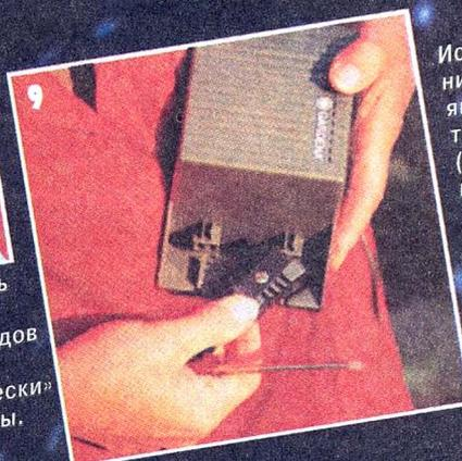
9 Источниками тока низкого напряжения являются трансформаторы (50 и 100 Вт), имеющие защиту от короткого замыкания и перегрузок.
