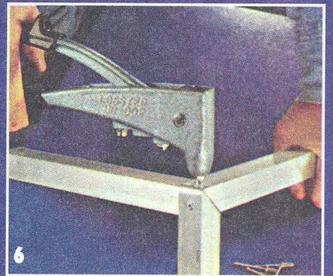
Алюминиевые профили можно прочно соединить на заклепках с отрываемым стержнем. Предварительно в заготовках сверлят отверстия, вставляют в них заклепки и специальными заклепочными клещами вытягивают и отрывают стержень. Такие заклепки пригодны и для соединения полых профилей.
