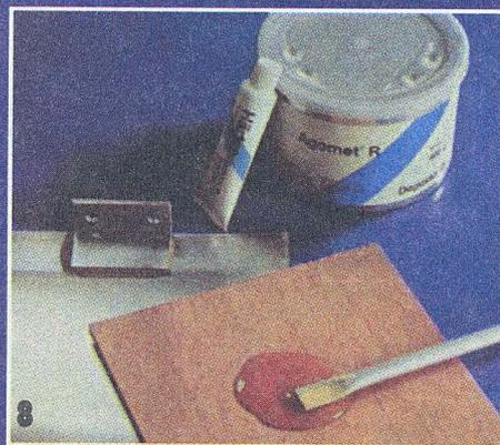
Достаточно высокую прочность имеет и соединение на эпоксидном клее. Соединяемые заготовки тщательно зачищают шлифовальной шкуркой и обезжиривают растворителем. Эпоксидную смолу, в которую предварительно вводят отвердитель, наносят на подготовленные поверхности и плотно прижимают заготовки одну к другой на время полного отверждения клея.
